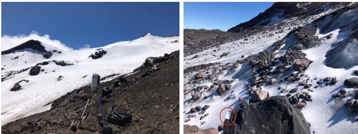
Figura 4: Registros fotográficos del levantamiento LiDAR durante la primera campaña período 2021-2022, con el círculo rojo mostrando un reflector emplazado en una roca sobre el glaciar (Fuente: Propia).
