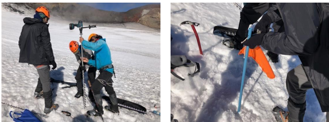
Figura 3: Registros fotográficos del procedimiento empleado por el equipo de trabajo para la instalación de balizas de ablación (PVC) en el glaciar CL108116004 durante la primera campaña período 2021-2022 (Fuente: Propia).
