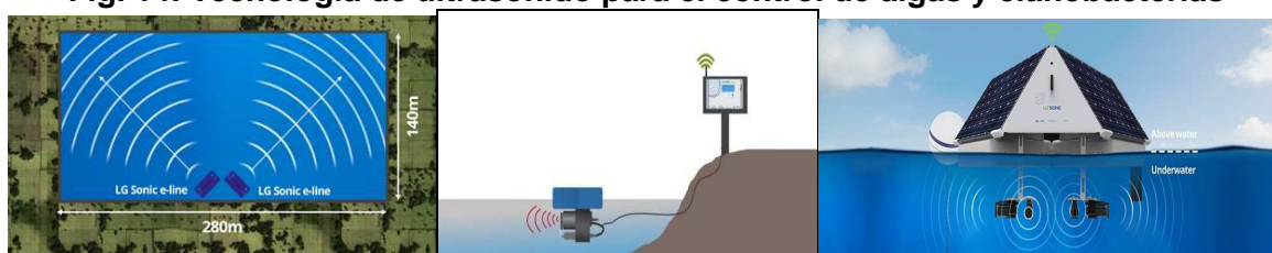
Fig. 14: Tecnología de ultrasonido para el control de algas y cianobacterias
