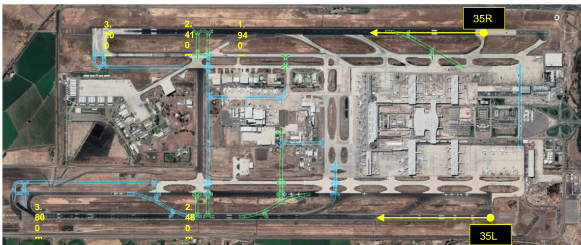
Figura 3-2. Esquema ubicación calles de rodaje de salida de pistas – Situación base y mejoras – Configuración sur Pistas 35R y 35L.
