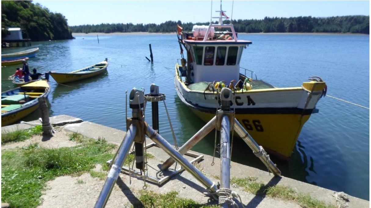
Figura N°40 ADCP's marca NORTEK modelo Aquadopp Profiler y esqueletos de anclaje.Río Queule, febrero-marzo de 2014.
