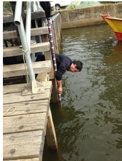
Figura N°30 Vista de la regla de marea instalada en Río Queule. Febrero- Marzo de 2014.
