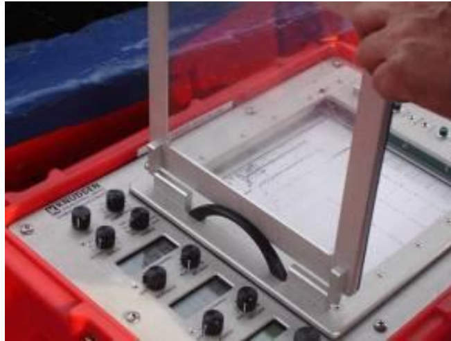
Figura N°16 Ecosonda Knudsen 320 MP.
