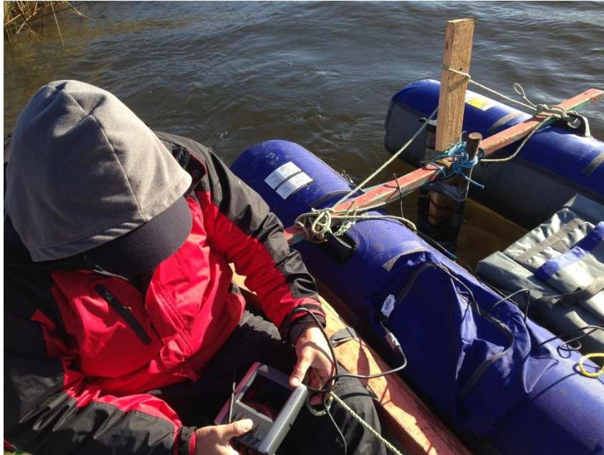
Figura N°83 Minizodiac utilizado para realizar el aforo. Se observa la operación del ecosondas desde superficie.
