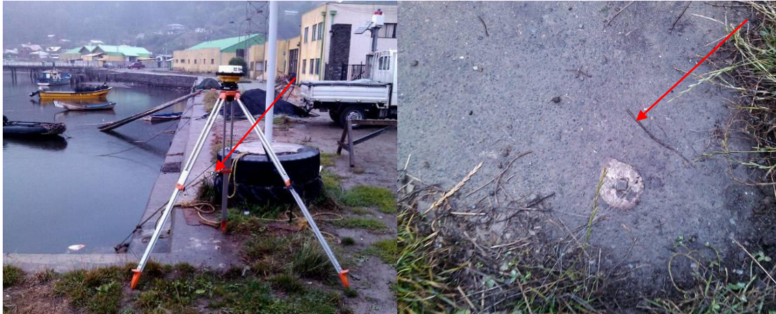
Figura N°15 Vértice QUE2 usado para el apoyo de la batimetría.
