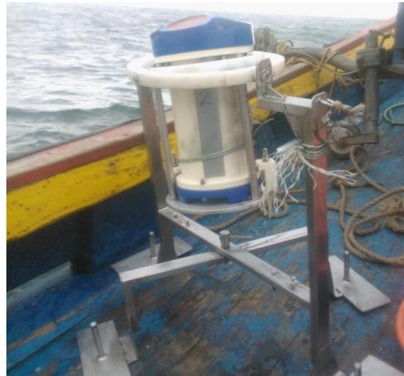
Figura N°71 Instrumento de medición de oleaje in situ con armazón de fondeo.
