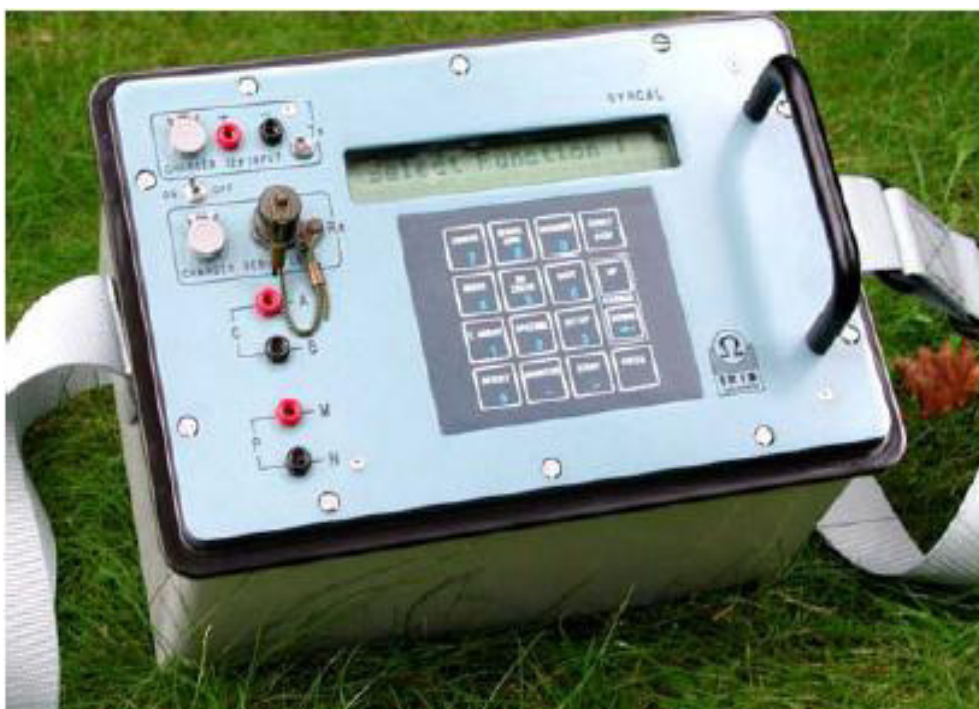
Figura 32. Equipo geoelectrico Syscal R1 Plus SW72 (Iris Instruments).
