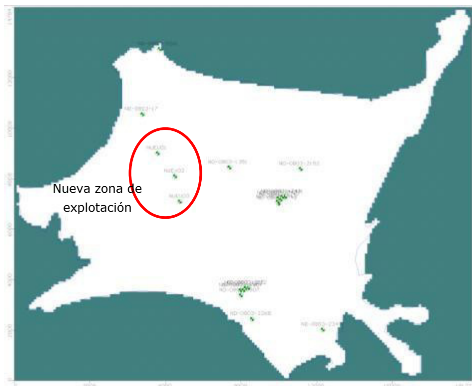
Figura 114. Distribución de captaciones con derechos otorgados y suposición de nueva zona para suministro industrial
