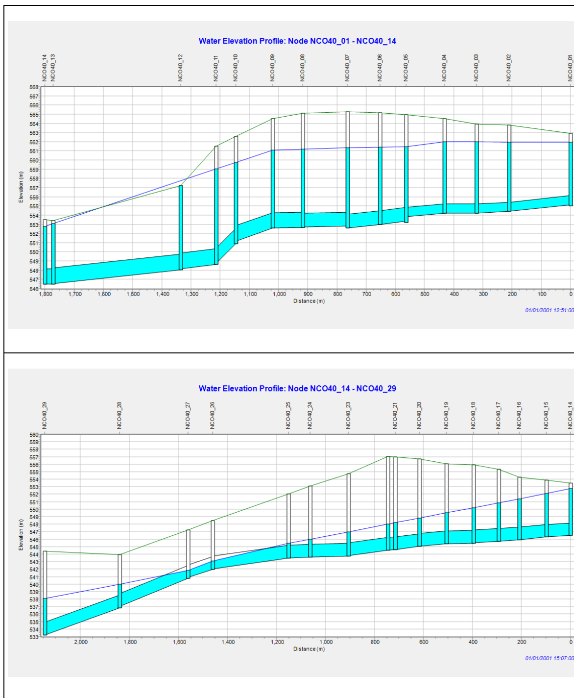
FIGURA 1-2: PERFIL LONGITUDINAL COLECTOR ZONA SUR, T=10 AÑOS, D=24 HORAS.
