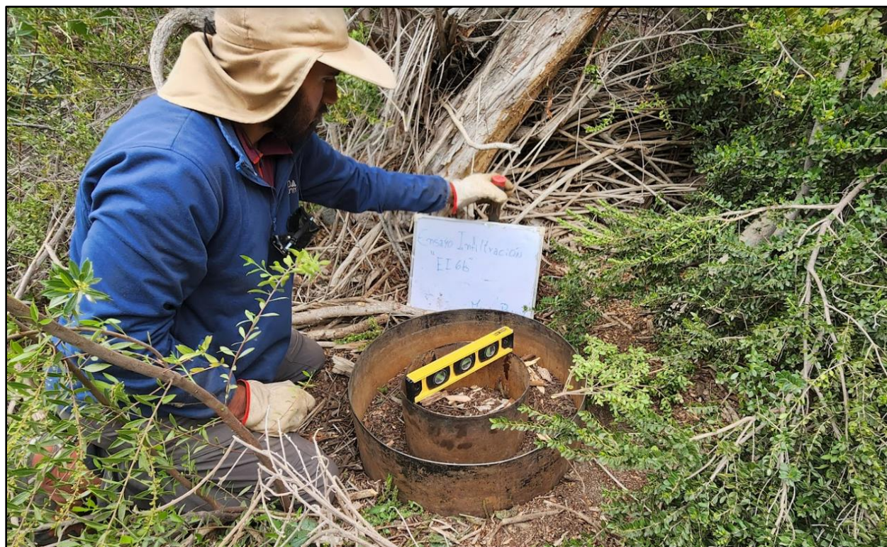
Figura 3.4. Registro del descenso del nivel en el infiltrómetro de doble anillo. Fuente: Elaboración Propia.
