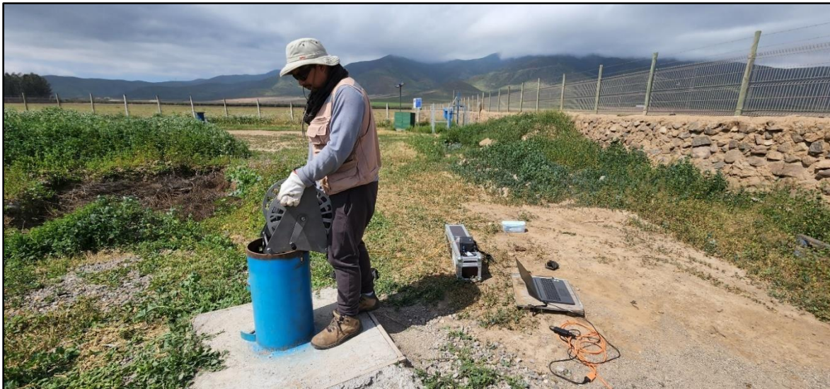
Figura 3.5. Instalación del equipo Gamma Natural. Fuente: Elaboración Propia.
