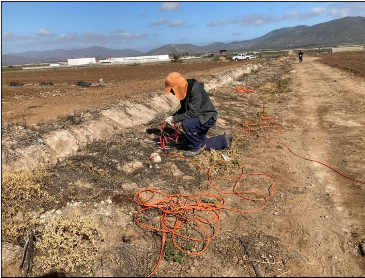
Figura 3.6. Configuración en terreno de la tomografía eléctrica. Fuente: Elaboración Propia.
