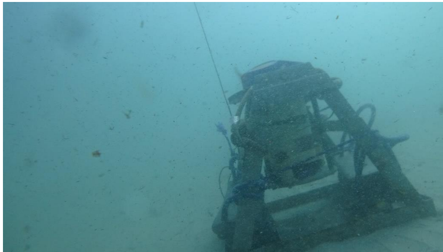
Imagen 7-9 Instalación de ADCP Teledyne RDI.
