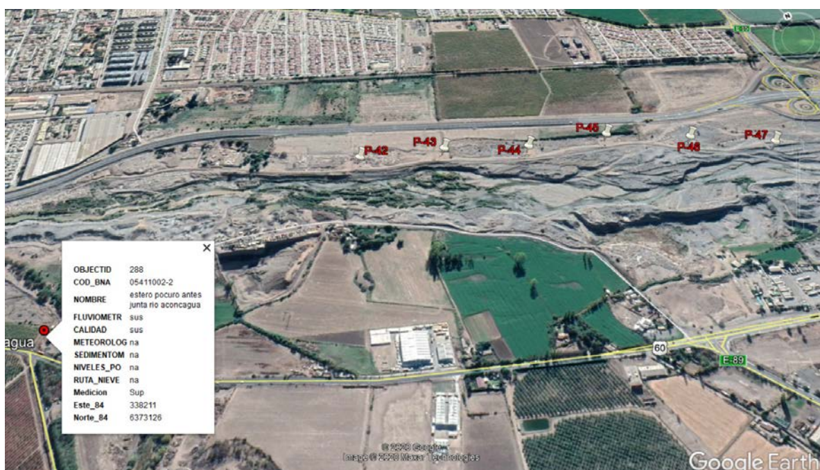
Figura 5.4-1 Pozos de extracción en construcción por el DPR-DOH. Cada pozo extrae 150 l/s. Escenario E2
