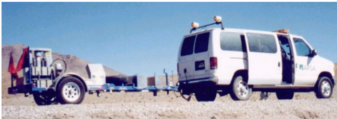
FIGURA 3. DEFLECTÓMETRO DE IMPACTO DYNATEST FWD 8000
