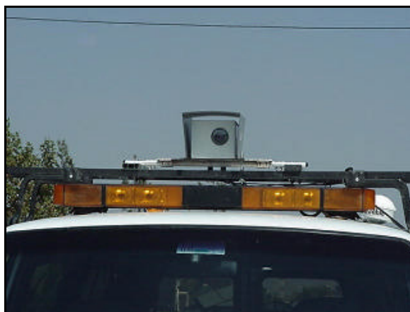
FIGURA 152. SISTEMA DE OBTENCIÓN DE VIDEO SOBRE UN VEHÍCULO.
