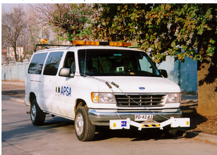
FIGURA 1. PERFILÓMETRO LÁSER, MODELO ARRB "TWO LASER PROFILER" (TLP).
