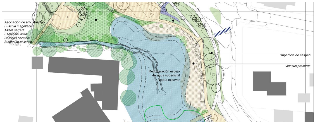
Imagen 5-17: Se indica sector de obras de recuperación del espejo de agua, actualmente área pantanosa y contaminada. A la izquierda arriba el área de recuperación ecológica, con formación arbustiva y a la derecha, adyacente al sendero, se propone juncales.
