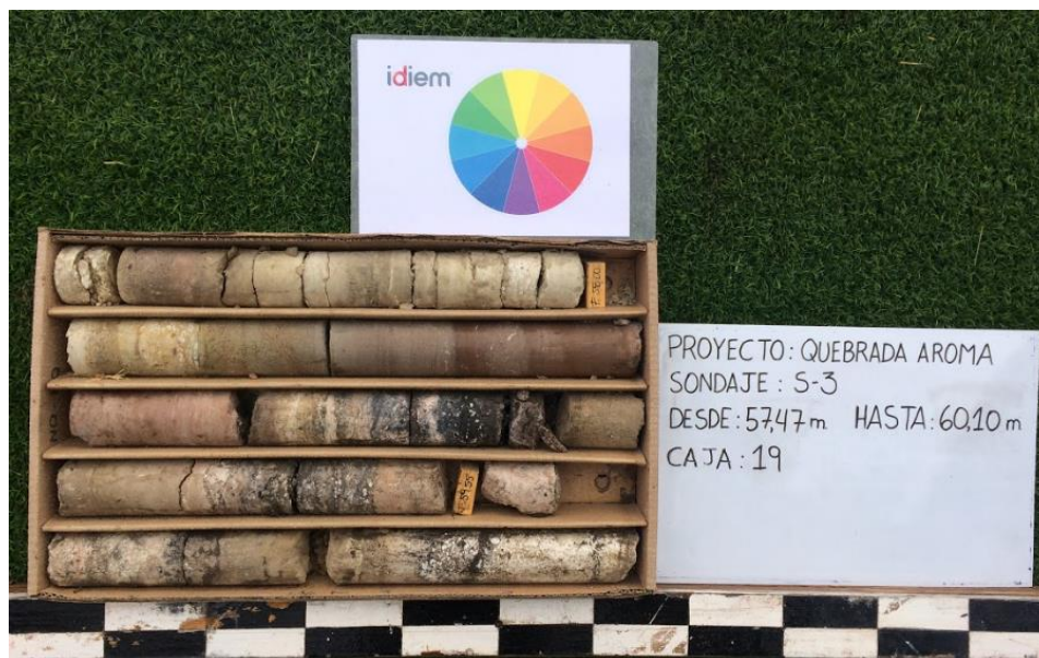
Proyecto: Prospecciones geotécnicas Quebrada Aroma Sondaje: S-3 Caja N°19:– Desde 57,47 m a 60,10 m
