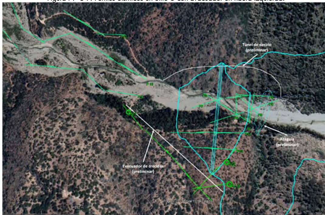
Figura N° 3-9: Perfiles Sísmicos en Sitio 3 con Evacuador en ribera izquierda.
