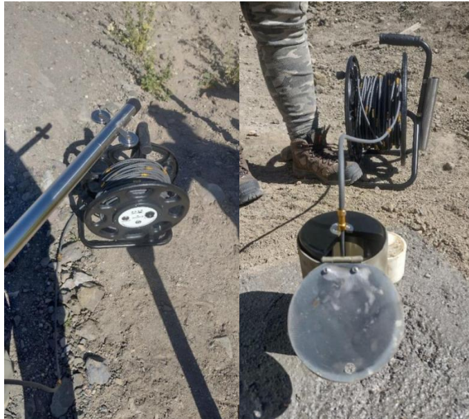
Figura 12 Inclinómetro. A la izquierda se muestra el inclinómetro utilizado en este estudio. A la derecha, se muestra el tapón, la funda metálica de cierre y la toma de datos.
