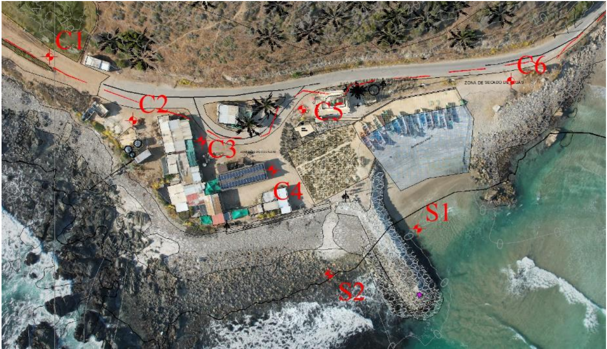
imagen 3-1 Ubicación de sondaje y calicatas
