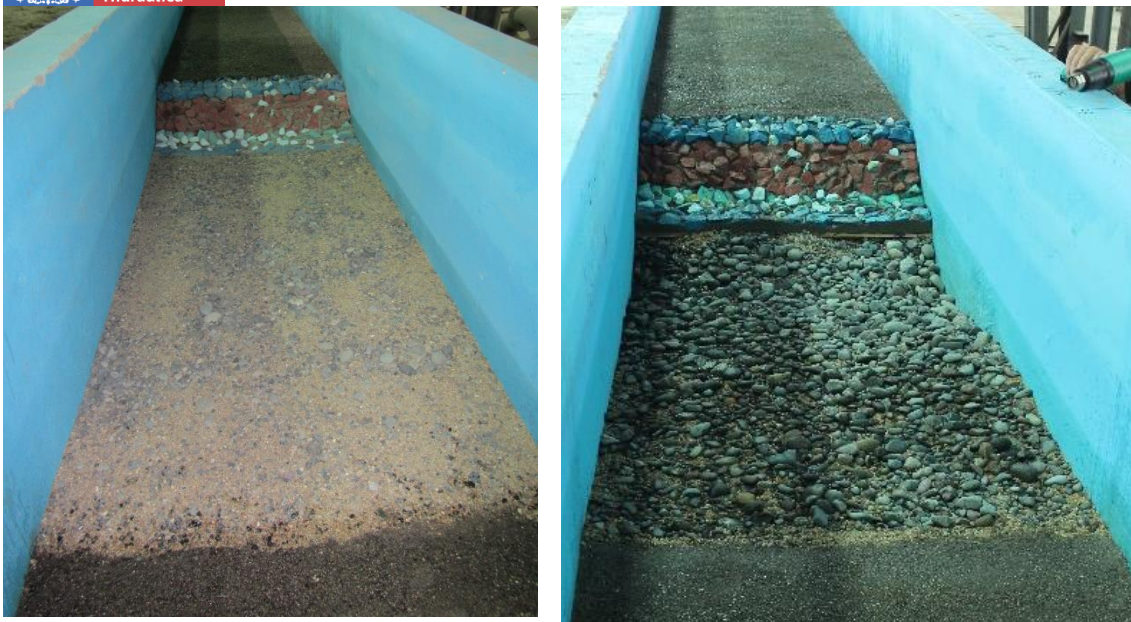
Figura 5-6: Sedimento lecho móvil experiencia tipo I. Tr=100 años. A la izquierda al inicio de la experiencia. A la derecha, al final de la experiencia.
