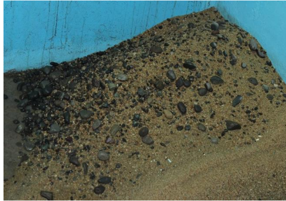
Figura 5-9: Material removido del tramo de lecho móvil. Experiencia tipo I. T_r=100 años.
