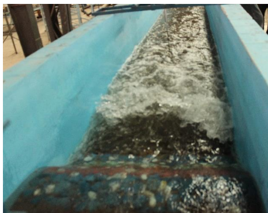
Figura 5-3: Flujo Aguas abajo del muro guardaradier.
