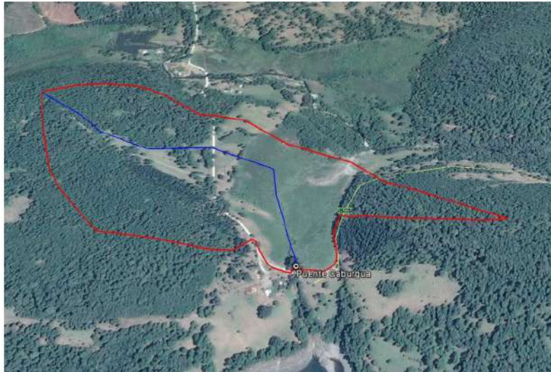
Figura 2.1: Cuenca asociada al puente Caburgua. Fuente: Ministerio de Obras Públicas (2014b)
