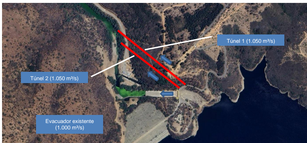
Figura 3.4 – Esquema propuesta 2, 2 túneles (Fuente: Ref. [3])
