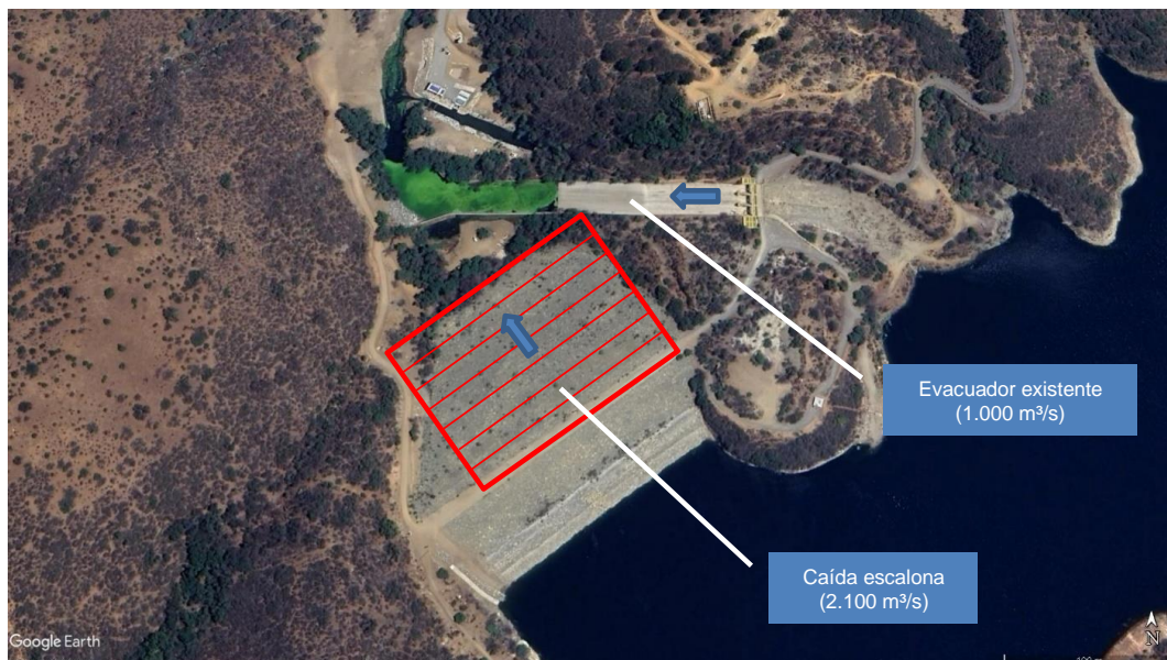
Figura 3.3 – Esquema propuesta 1, presa rebalsable (Fuente: Ref. [3])
