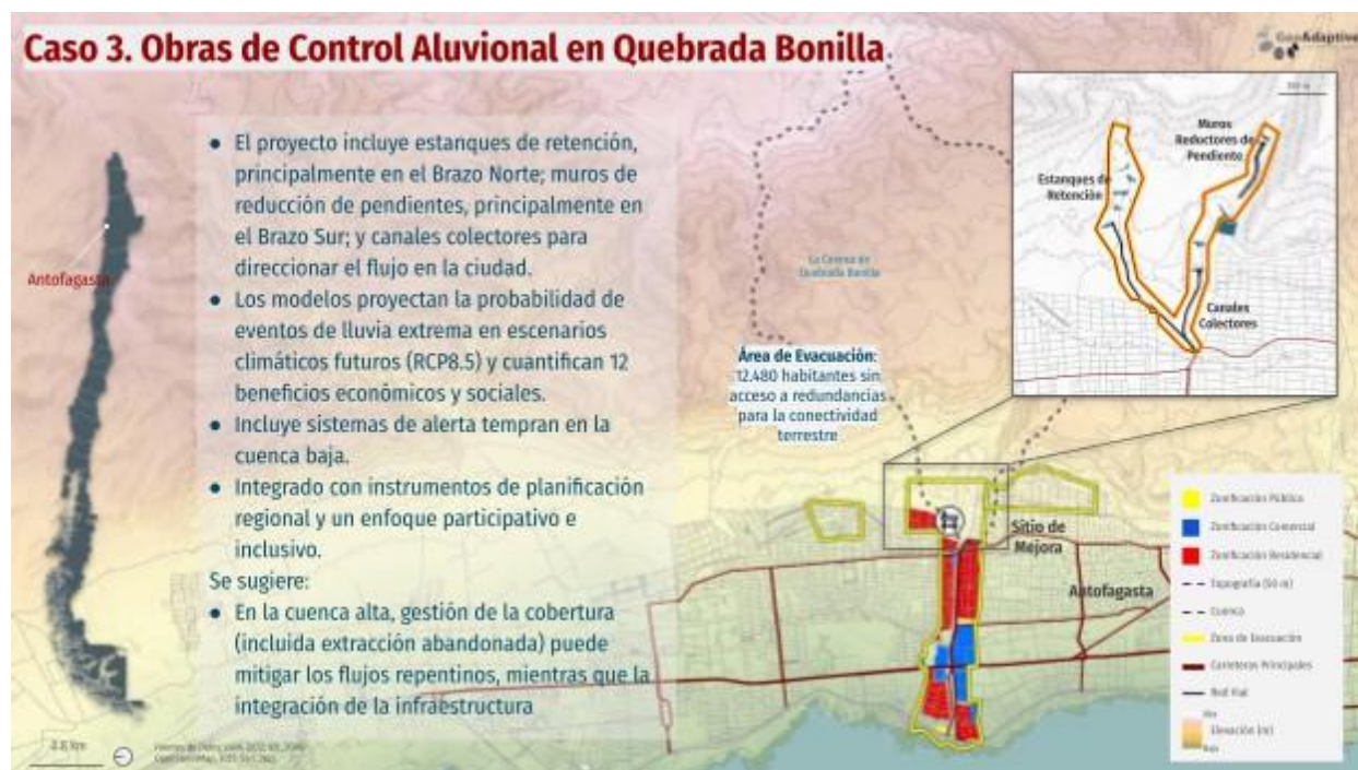
Figura A4-2.7. Caso 3. Obras de Control Aluvional en Quebrada Bonilla. Fuente: Elaboración propia, 2025.
