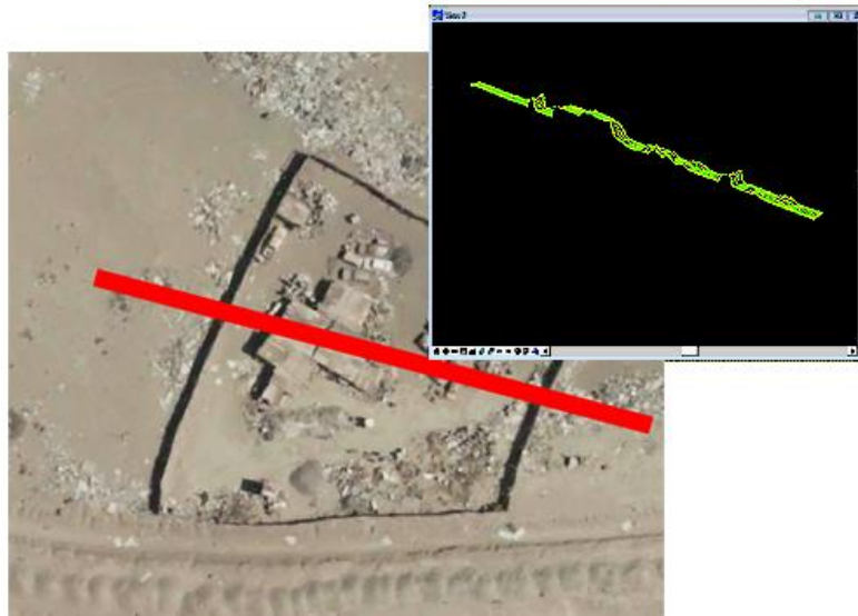
Figura 2-9. Clasificación Manual de la Nube de Puntos
