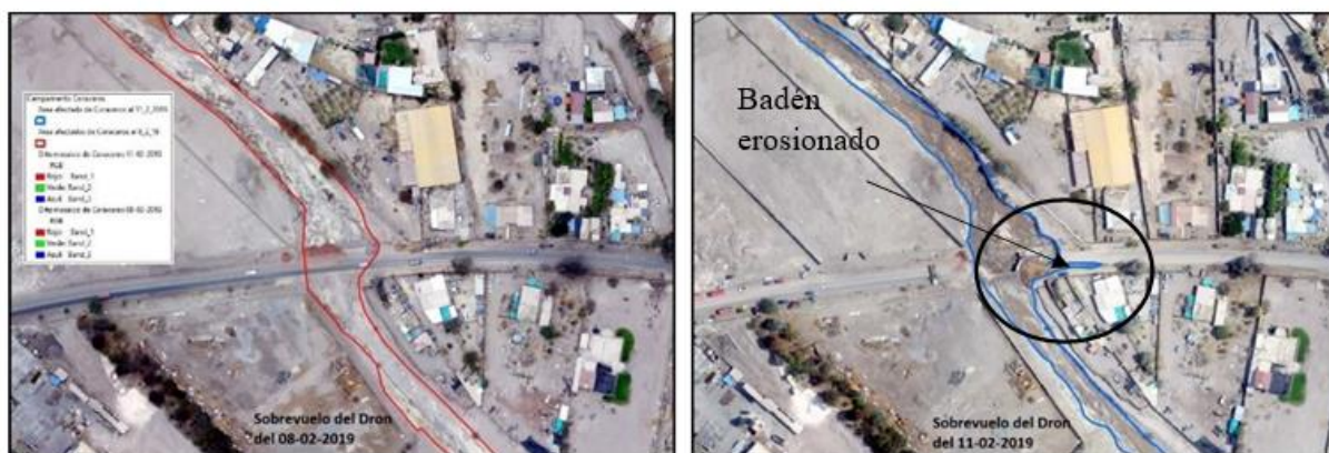
Figura 1-10. Efectos erosivos, observados en el mapeo de las ortofotos del 8 y 11-02-2019.
