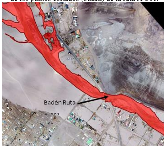
Figura 1-108. Zonas afectadas por inundación en la quebrada de Acha. La flecha negra indica uno de los puntos cortados (badén) de la ruta A-301.
