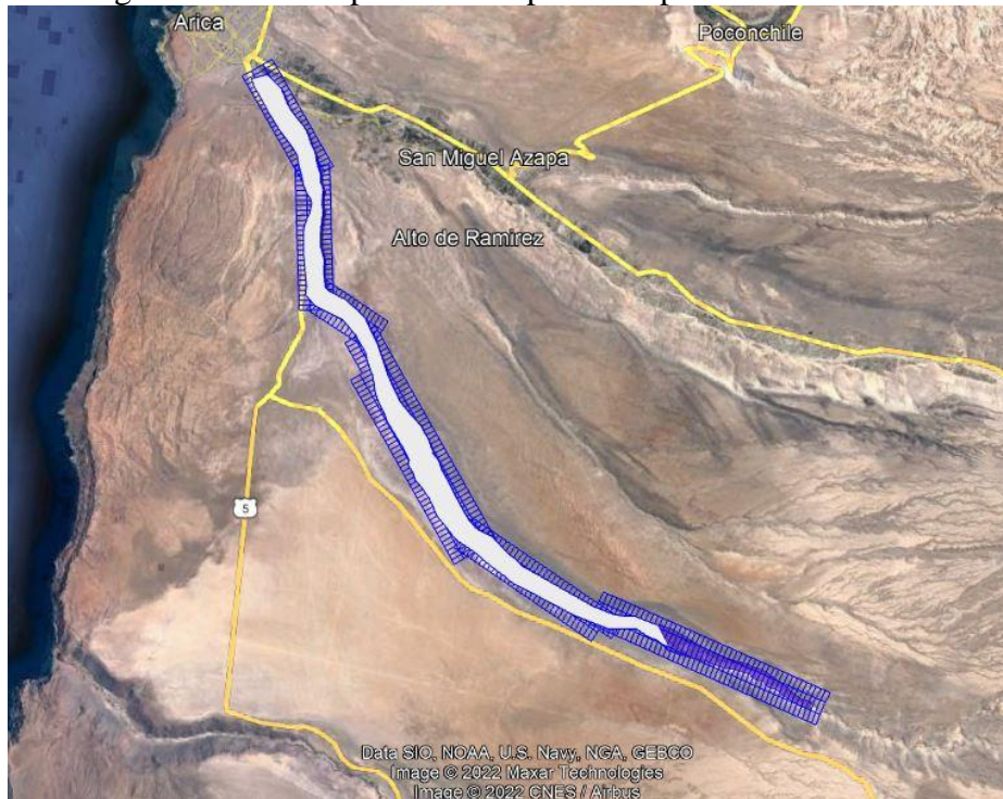
Figura 2-3. Líneas planificadas para la captura de datos láser.
