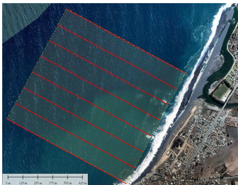
Área definida para el levantamiento batimétrico en el sector de Pelluhue.
