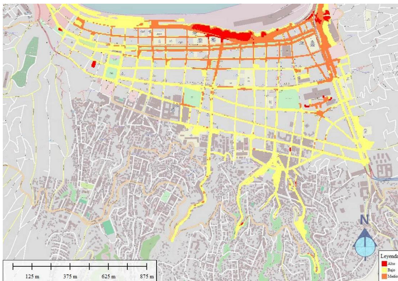
Figura N° 3-22 Alturas de inundación clasificadas, cuencas Uruguay y Francia, obtenidas a partir de modelo FLO2D
