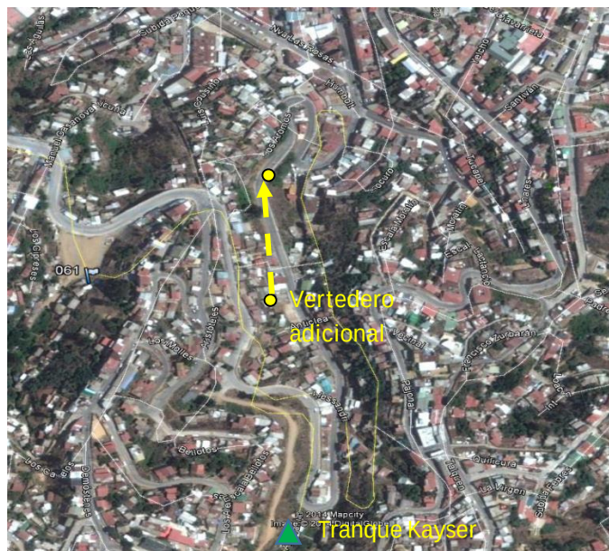
Figura N° 3-5 Condición de sobrepaso en calle Alessandri y posterior tránsito en quebrada aledaña
