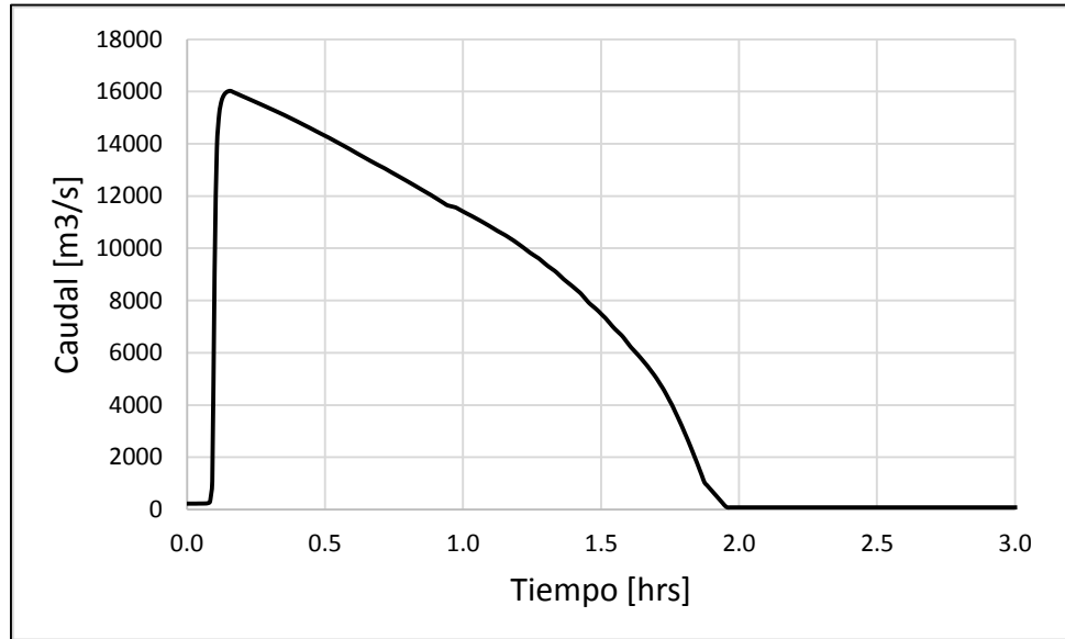
Figura 4.4 Hidrograma de rotura por sobrevertimiento a propagar.
