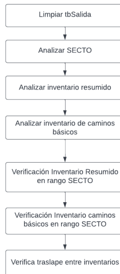
Figura 10-4: Diagrama de flujo para el proceso de análisis de consistencia de datos.
