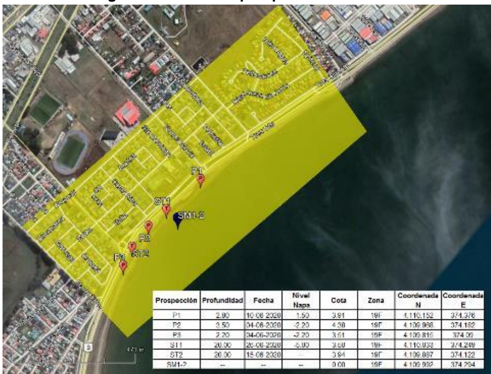
Figura 2.6 Planta de prospecciones Tramo4.
