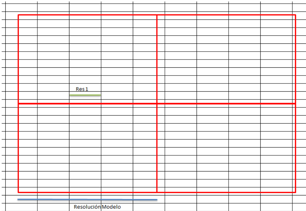
Figura A.4 Ilustración de la agrupación de información a partir de píxeles de menor resolución, a las celdas del modelo.
