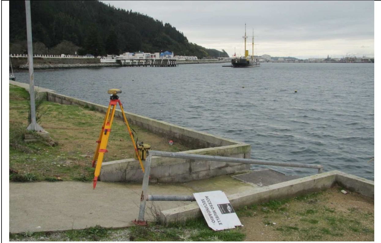
Figura N° 2.3-1: Ubicación vértice IT1 en muro de atraque Capitanía de Puerto de Talcahuano.
