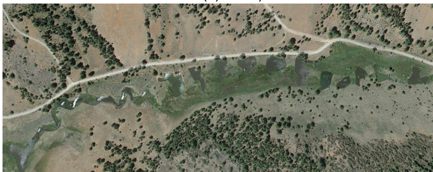
Figura C8. 31. Primera implementación (2006) de técnica de “ plug and pond ” (“taco y estanque”) en California, Feather River Watershed - Red Clover / McReynolds Creek Project. Fuente: Plumas Corporation. https://plumascorp.org/
