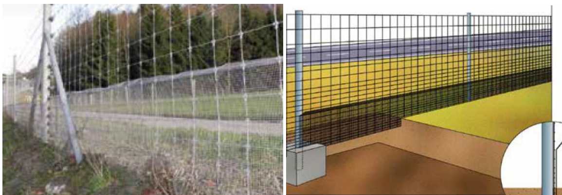
Figura C8. 59. Referencia real de doble enrejado de diferente ancho para evitar el paso de mamíferos pequeños en su parte más baja (izquierda); esquema de un enrejado con refuerzo tipo visera en ángulo de 45° hacia el exterior (derecha). Fuente: Ministerio de Agricultura, Alimentación y Medio Ambiente – España (2015).
