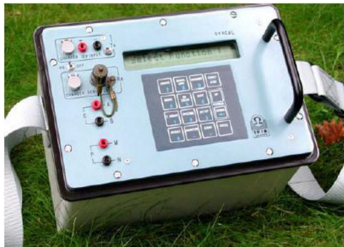
Figura 26. Equipo geoelectrico Syscal R1 Plus SW72 (Iris Instruments).
