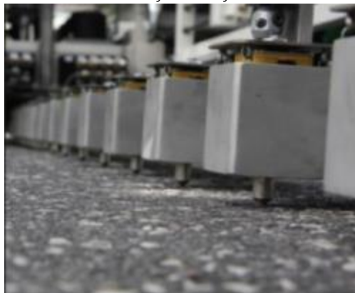
Figura 3.16: Distribución de Geófonos Deflectómetro de Impacto FWD.
