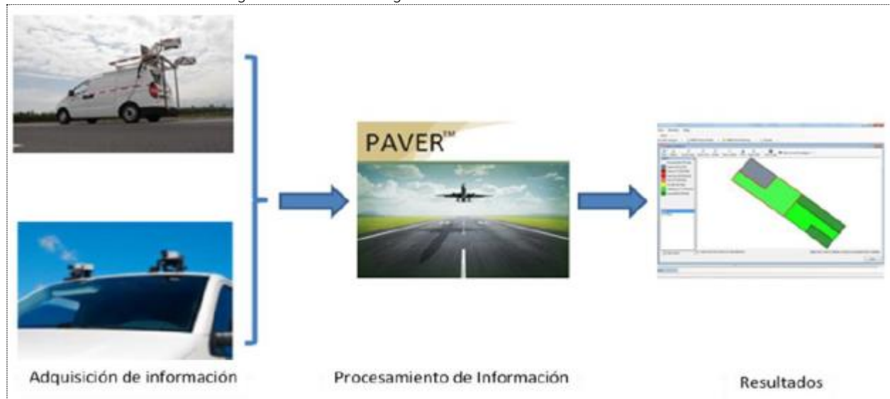
Figura 1.11: Metodología semiautomatizada cálculo del PCI
