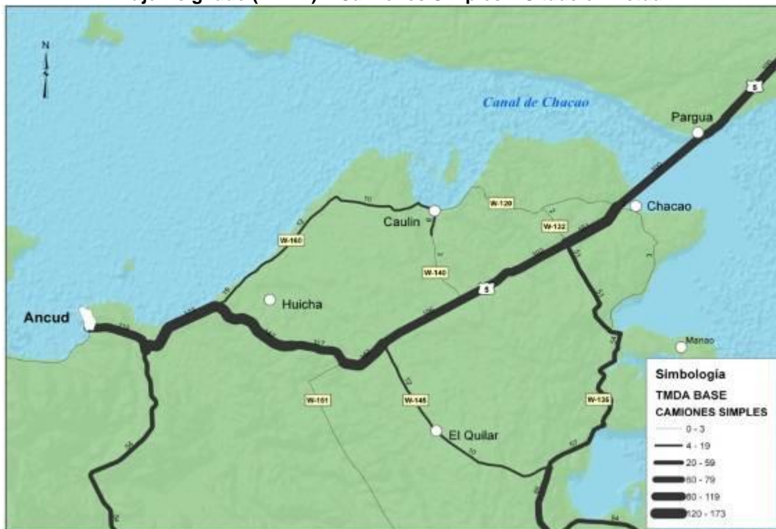
Figura N° 3-4 Flujo Asignado (TMDA) – Camiones Simples – Situación Actual
