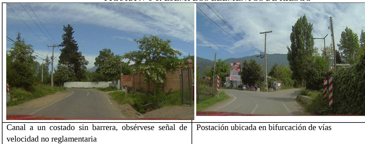
FIGURA N°6-6: EJEMPLOS ELEMENTOS DE RIESGO
