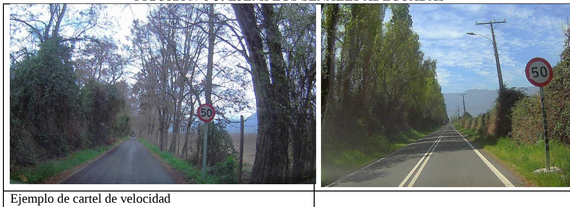
FIGURA N°6-3: EJEMPLOS SEÑALES ADECUADAS
