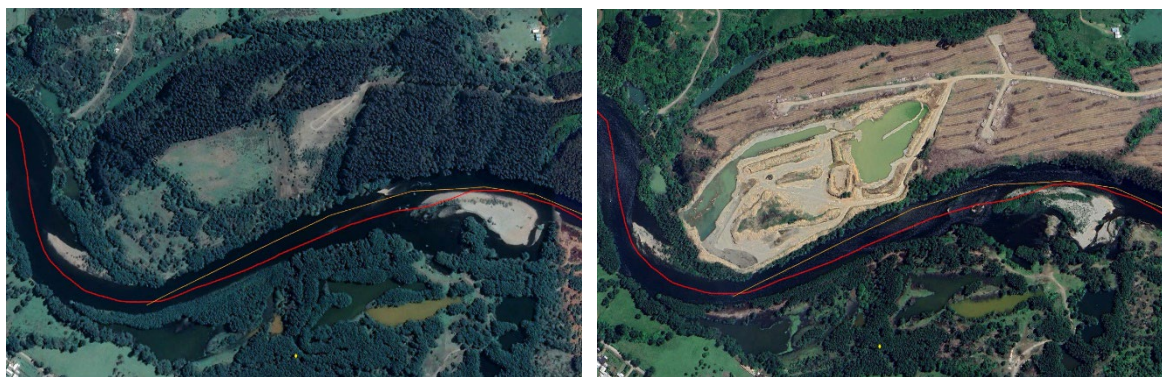
Figura C7. 46. Zona de extracción de áridos antes (izquierda) y después (derecha) de iniciada la faena, 2,000 m aguas arriba de la zona de obras, en ribera norte del Río Cruces, subcuenca del Río Cruces en el área de obras de puente del segundo acceso a San José de La Mariquina. Fuente: Extraída de Google Earth.
