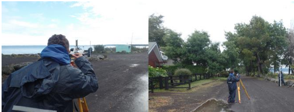
Figura 4-9 Nivelación interna entre vértices sector Cascadas - Lago Llanquihue
