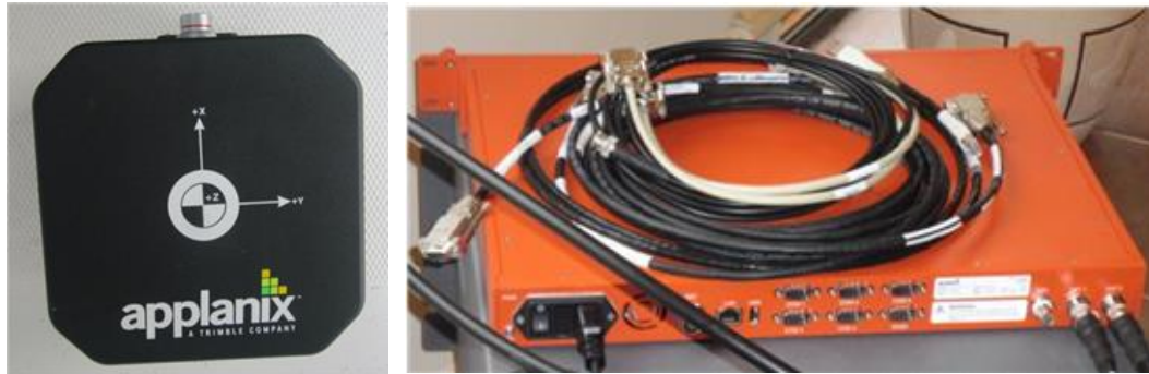
Figura 4-17 Sistema inercial APPLANIX, POS-MV Wavemaster V5
