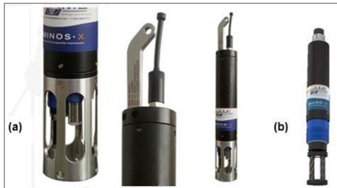
Figura 4-18 Sondas de medición de la velocidad del sonido (SVP). (a) Perfilador AML Minos-X (NS 30202) y (b) AML Micro-X (NS 10266)
