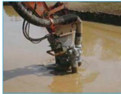
HY85B + 2 EXHY20: acoplado en una retro Fiat Hitachi FH 300 (Italia).
