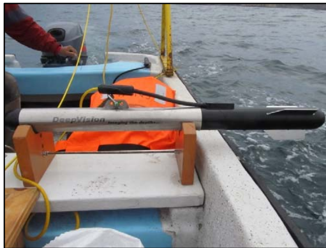
Foto 9-18 Sonar de barrido lateral considerado para su empleo en la prospección
