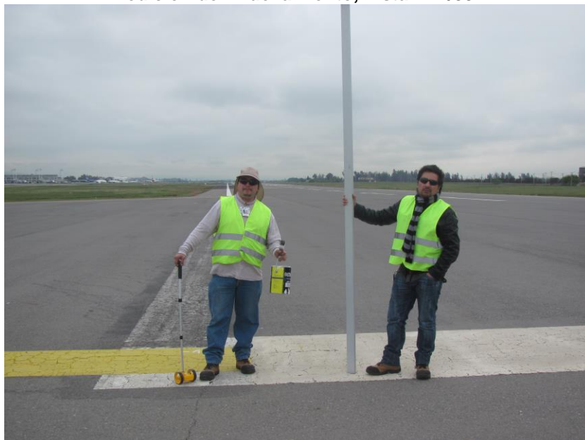
Figura N° 3-5 Medición de Ahuellamiento, Pista 17R/35L
