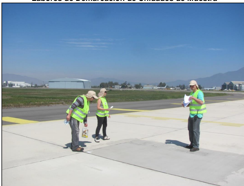
Figura N° 3-3 Labores de Demarcación de Unidades de Muestra
