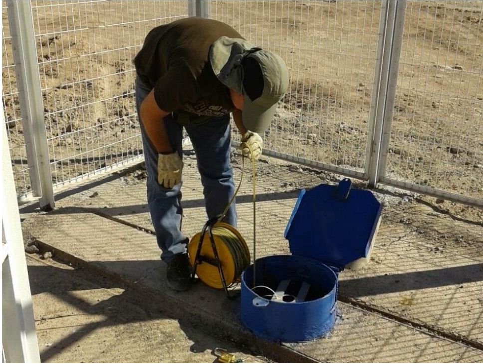
Figura 7-5 Empleo de pozómetro para la medición del nivel de aguas subterráneas.
