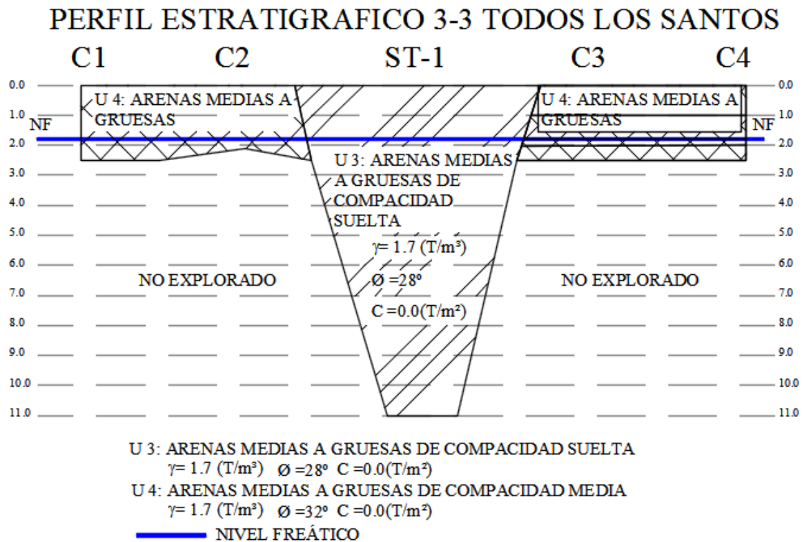
Figura 8-17 Perfil estratigráfico 3-3 estimado, sector Petrohué, lago Todos los Santos.
