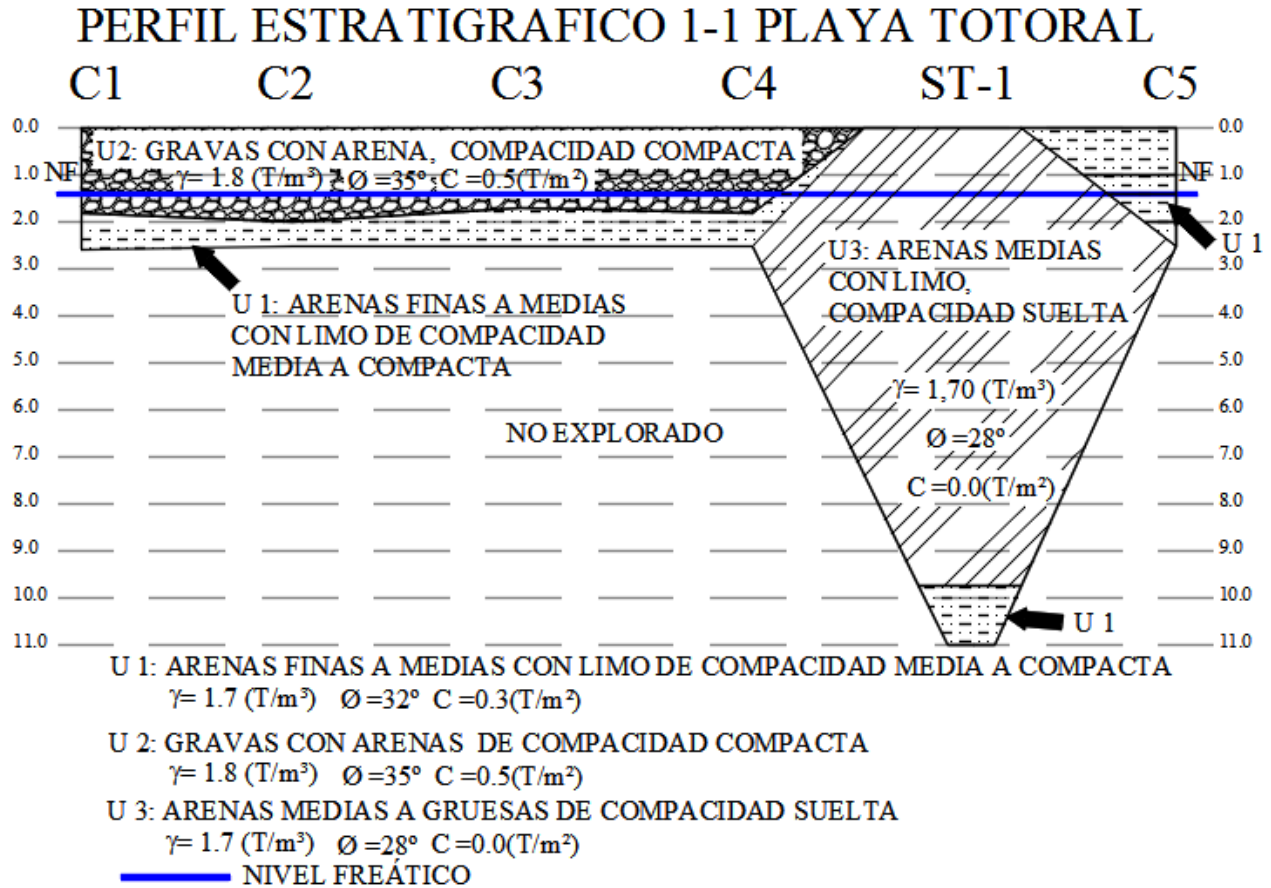
Figura 8-11 Perfil estratigráfico 1-1 estimado, Totoral
