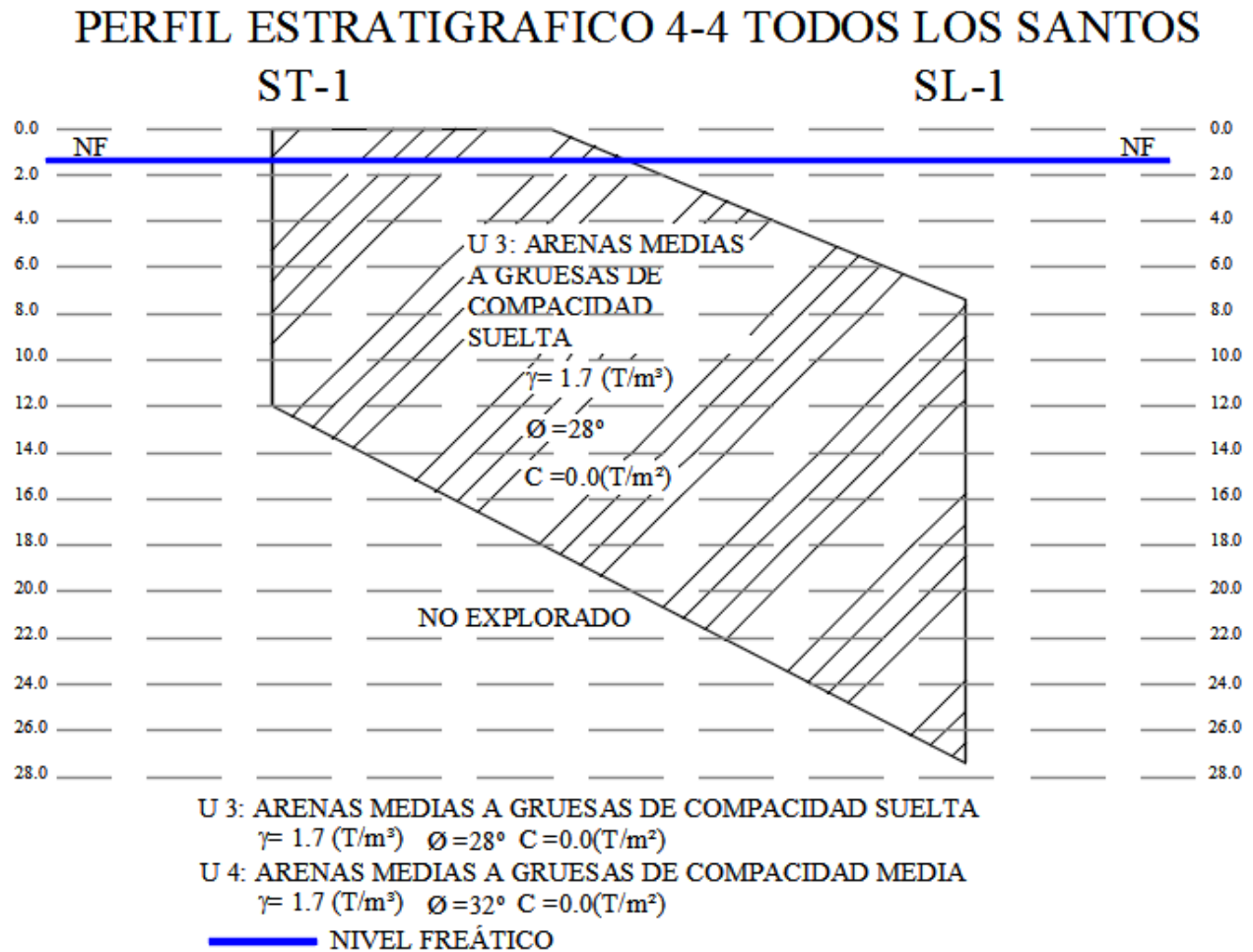
Figura 8-18 Perfil estratigráfico 4-4 estimado, sector Petrohué, lago Todos los Santos.
