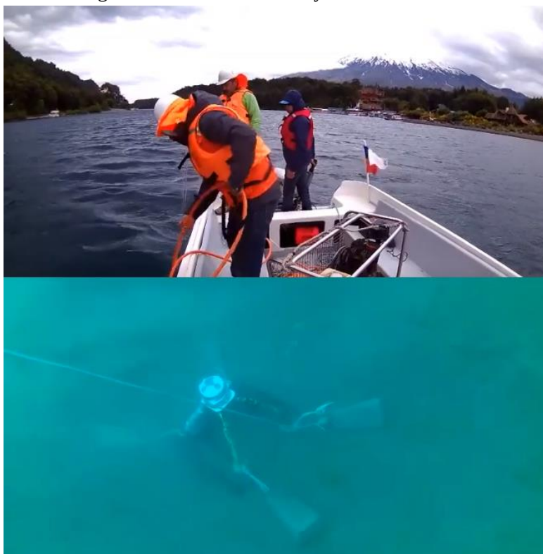
Figura 7.2: Faena de Buceo y ADCP Fondeada.
