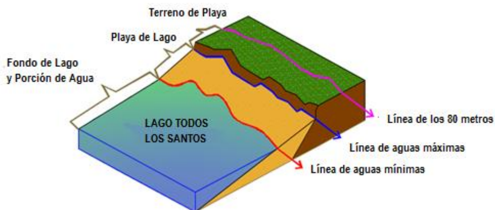
Figura 3-15 Esquema de Conceptual de la Determinación de Línea de Playa
