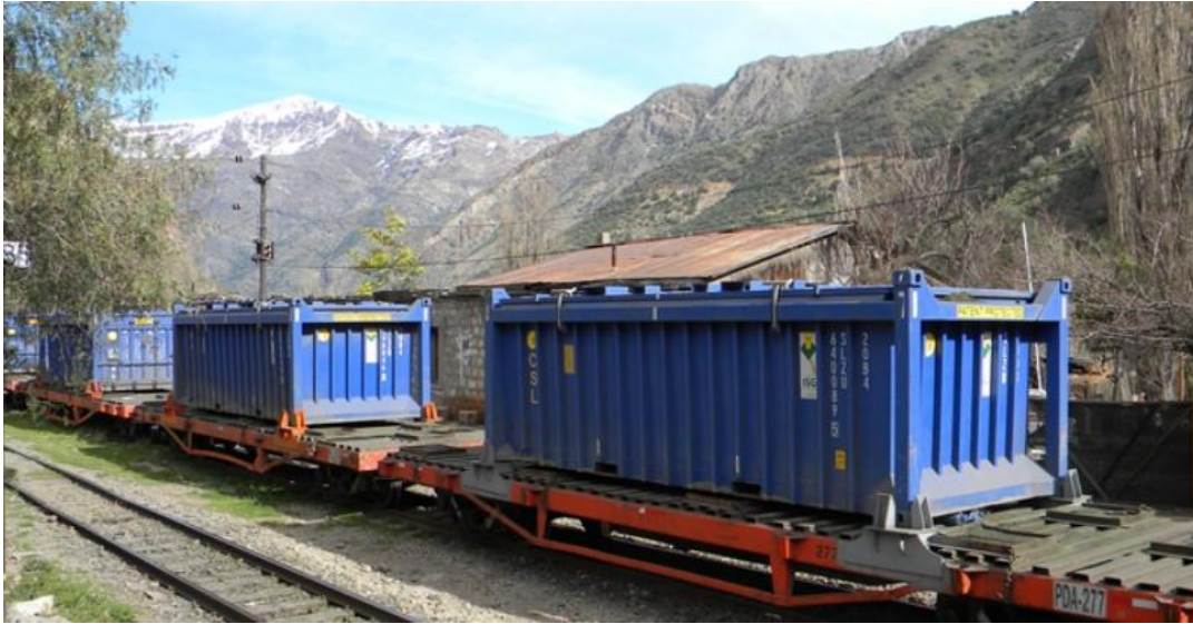
Figura N°2.5- 16: Concentrado de Cobre en carros estanques a Puerto Ventanas, desde Los Lirios (Codelco Andina), Las Blancas (Anglo American) y desde Saladillo (Codelco Andina)
