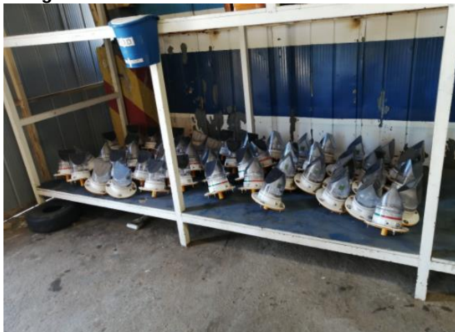
Figura N° 1.1-12: Luces Portátiles Fotovoltaicas
