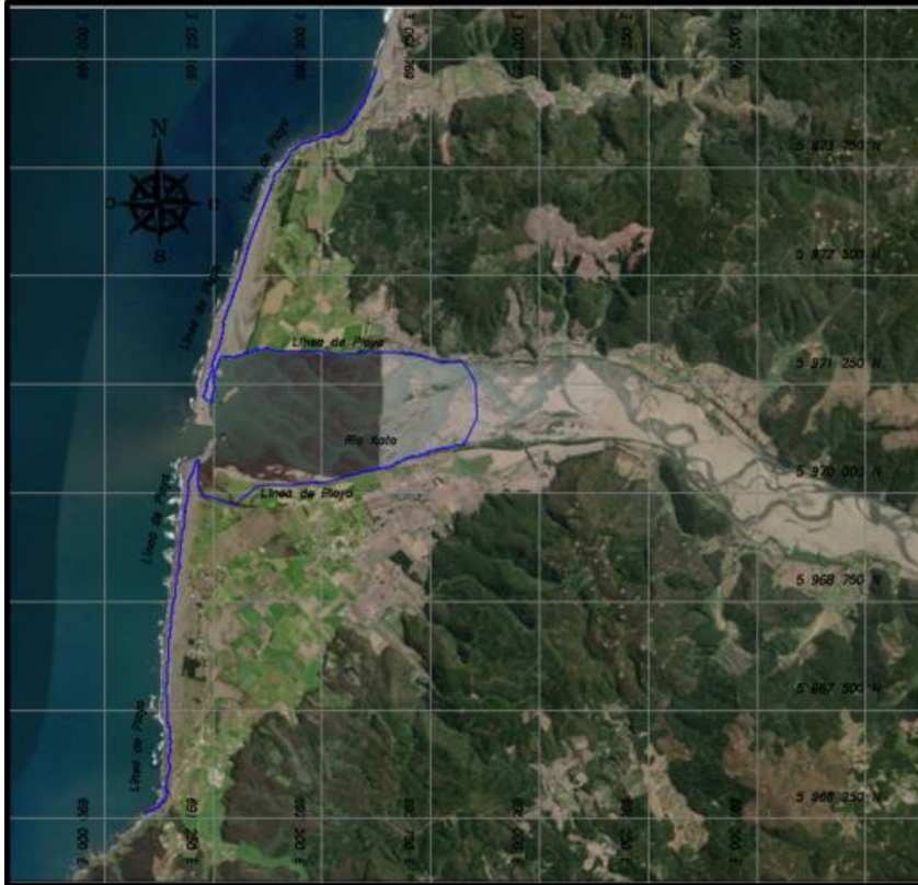
Figura N° 4.3: Levantamiento línea de playa.
