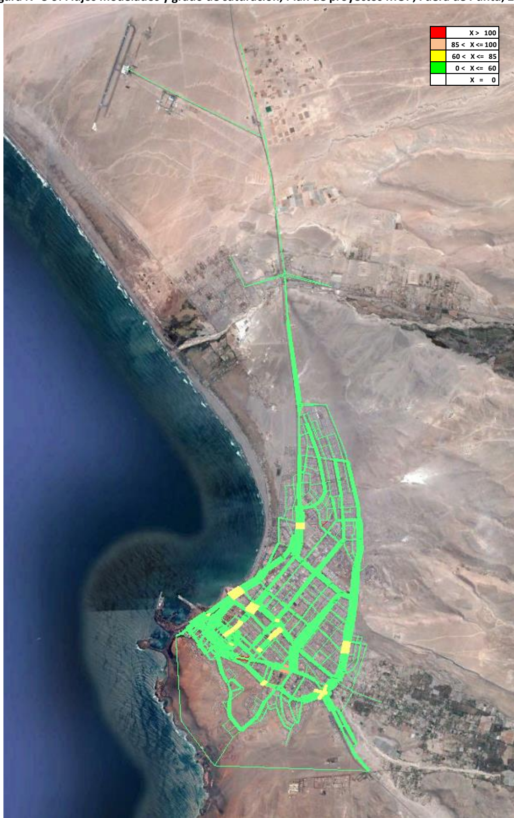
Figura N° 8-9: Flujos modelados y grado de saturación, Plan de proyectos MOP, Fuera de Punta, 2030
