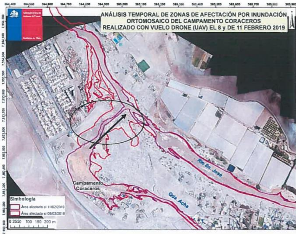
Figura 6-10. Análisis temporal de las zonas afectadas por inundación por el campamento Coraceros del 8 y 11 de febrero de 2019. El círculo indica el canal excavado para desagüe hacia el río San José.
