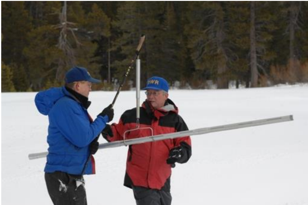
Figura 3.2: Medición de equivalente en agua de nieve mediante testigo de nieve tomado por monterrosa. Fotografía: Departamento de recursos hídricos de California (2008).
