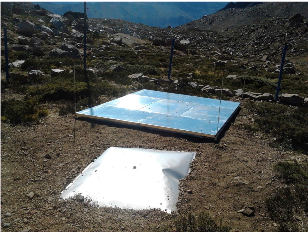
Figura 3.3: Instrumentos de medición continua de equivalente en agua de nieve: Snow Scale (superior) y Snow Pillow (inferior) en la estación DGA Laguna Negra. Fotografía: Miguel Lagos.
