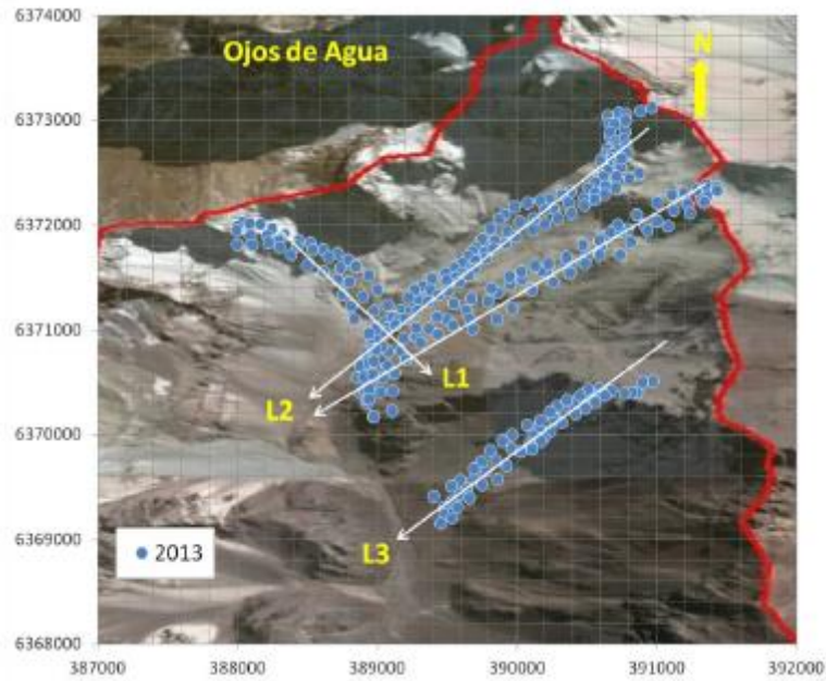
Figura 3.36: Mediciones del manto nival realizadas en transectas por esquiadores en el marco del proyecto DGA (2014b).
