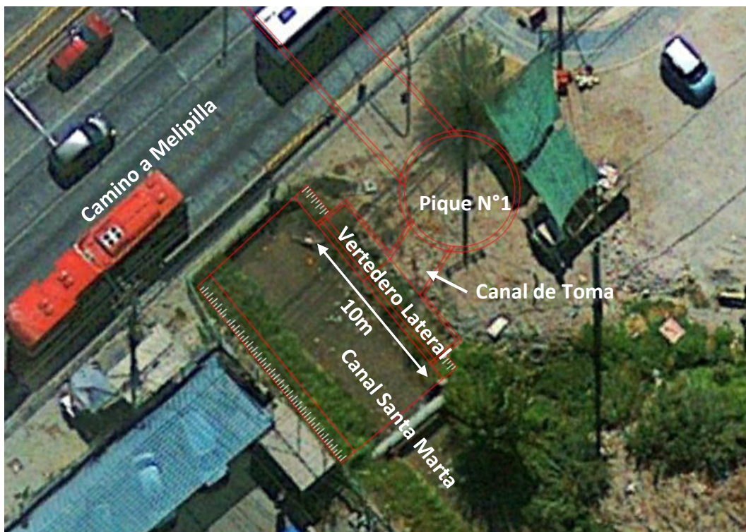
FIGURA 10-5: UBICACIÓN VERTEDERO LATERAL Y CANAL DE TOMA
