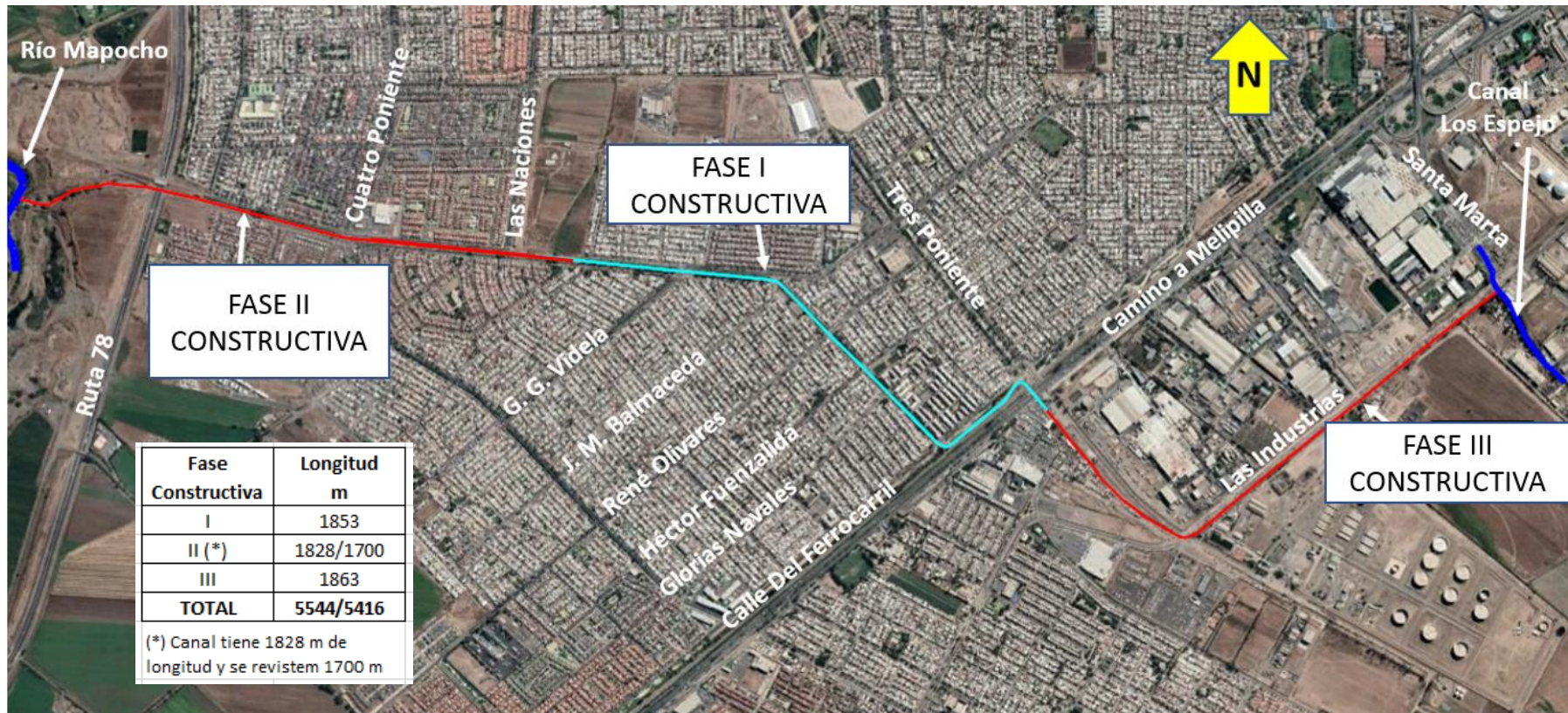
FIGURA 1-4: CANAL SANTA MARTA, FASES CONSTRUCTIVAS
