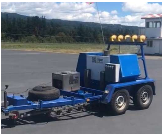
Figura 39: Deflectómetro de Impacto Pesado utilizado.
