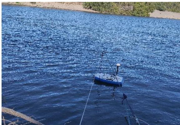
Figura 3-6 : Medición de caudal con RiverSurveyor
